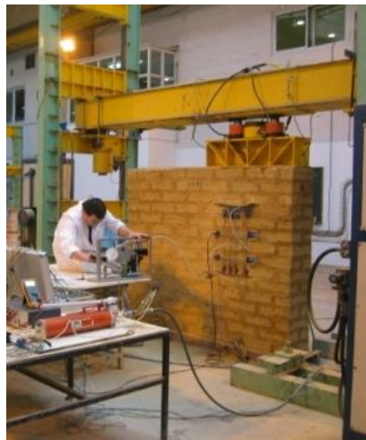
Figuras 4.7: Ensayos en laboratorio correspondientes a la Tesis Doctoral del ingeniero Ignacio Lombillo (2010) sobre ensayos ligeramente destructivos utilizados para la caracterización mecánica de estructuras de fábrica.
