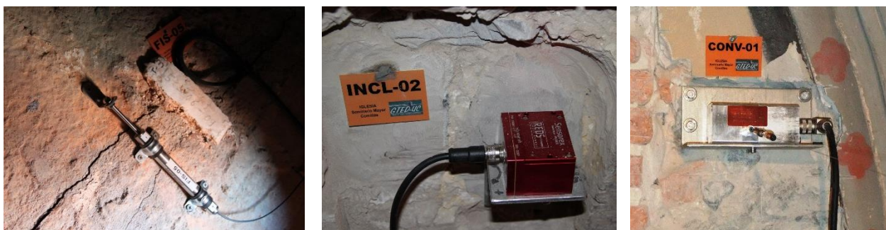
Figuras 4.3: Fisurómetro, inclinómetro y cinta de convergencia para medir en continuo la deformabilidad de elementos estructurales.
