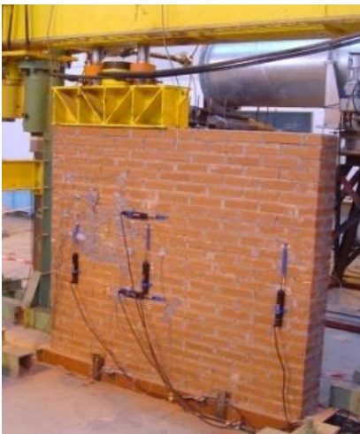
Figuras 4.7: Ensayos en laboratorio correspondientes a la Tesis Doctoral del ingeniero Ignacio Lombillo (2010) sobre ensayos ligeramente destructivos utilizados para la caracterización mecánica de estructuras de fábrica.
