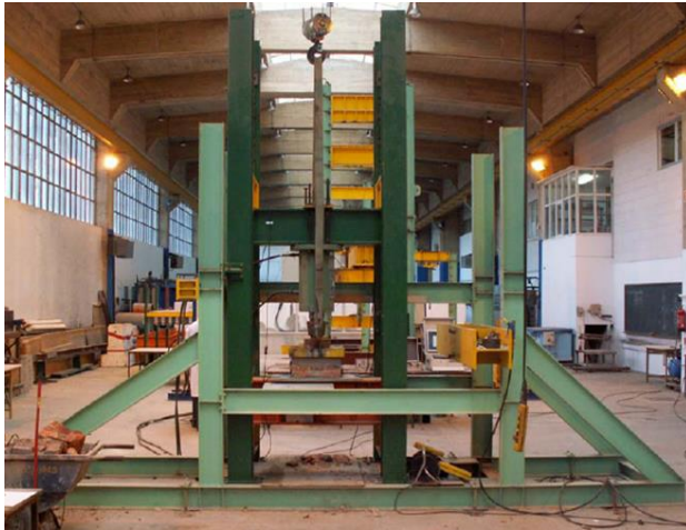
Figuras 4.6: Pórticos metálicos para ensayos del laboratorio de estructuras y ensayo de un muro de carga.
