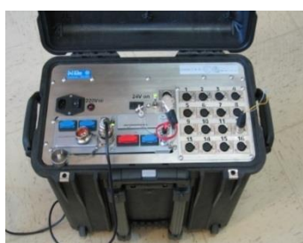
Figuras 3.2: Equipos utilizados por GTED en los “estudios previos” de construcciones que van a rehabilitarse: Data logger de 16 canales (izda.). Equipo sónico/ultrasonico (centro). Y Gatos planos (dcha.).
